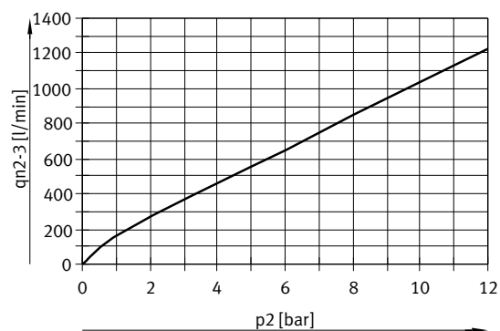
2 > 3 流量 q_n 与输出压力 p_2 的关系
