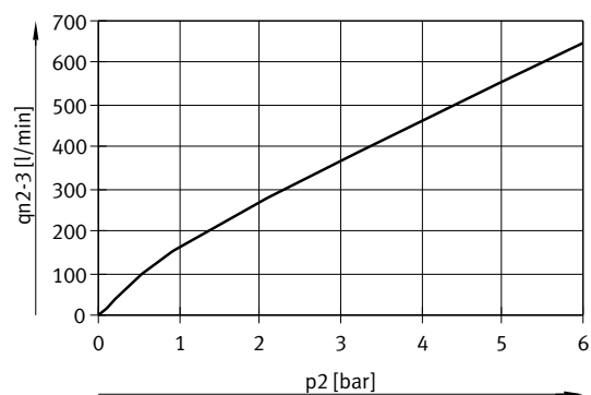
2 > 3 流量 q_n 与输出压力 p_2 的关系
