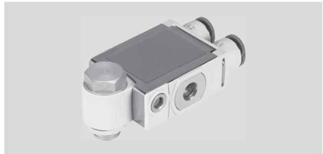
单向节流阀 VFOF-LE-BAH 组合了单向排气节流功能和带手动排气的先导止回阀功能。单向排气节流功能用于手动调节气动驱动器活塞杆的进退速度。
