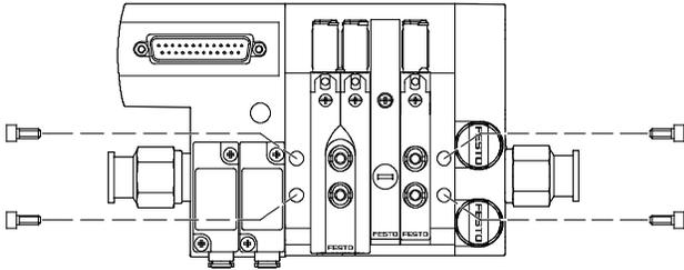
墙面安装四个通孔确保阀岛的装配牢固 (M5 螺丝)。
