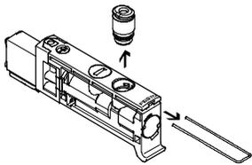
通过拆下弹簧夹，可快捷地更换接头 (气口 2/4)。通过插入堵头可密封气口 (→ 37)。
