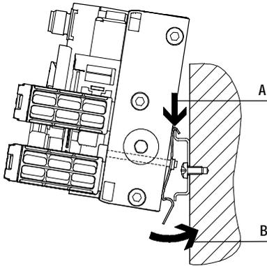
H型导轨安装 VAME-T-M5 由两个安装夹组成, 用于左右固定气路板 (M5 螺丝)。气路板上下面的通孔就用于此。
