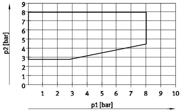
先导压力与工作压力的关系
