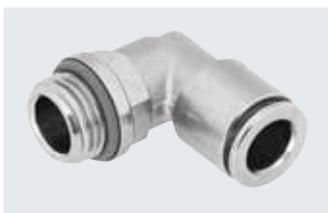
坚固的金属快插接头均为镀镍黄铜 (采用化学方法) 材质。高耐腐蚀等级 CRC 3, 且耐化学品。用于最高温度达 150°C、最大压力达 20 bar 的气动应用场合。适用气管外径包括 4, 6, 8, 10, 12 和 14 mm, 可配合连接螺纹: M5, M7 和 G1/8 ... G1/2。
