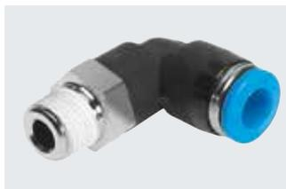
多种快插接头选择, 用于最高温度达 80°C、最大压力达 14 bar 的气动应用场合。适用气管外径包括 4, 6, 8, 10, 12, 16 和 22 mm, 可配合连接螺纹: R1/8 ... R1/2 和 G1/8 ... G3/4。
