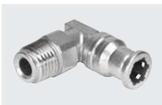
不锈钢快插接头。高耐腐蚀等级 CRC 4, 且耐化学品, 经认证可用于食品包装行业。用于最高温度达 120°C、最大压力达 10 bar 的气动应用场合。适用气管外径包括 4, 6, 8, 10, 12 和 16 mm, 可配合连接螺纹: M5 和 R1/8 ... R1/2。
