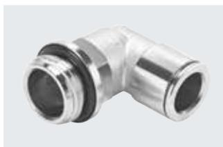
价格实惠的金属快插接头, 用于最高温度 70°C、最大压力达 16 bar 的气动应用场合。适用气管外径包括 3, 4, 6, 8, 10, 12 和 14 mm, 可配合连接螺纹: M5, M7 和 G1/8 ... G1/2。
