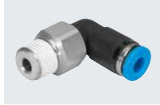
快插接头, 带旋转接口, 可旋转 360°。滚珠轴承在旋转运动场合中最大转速可达 500 rpm。用于最高温度达 60°C、最大压力达 14 bar 的气动应用场合。适用气管外径包括 4, 6, 8, 10 和 12 mm, 可配合连接螺纹: M5, R1/8 ... R1/2 和 G1/8 ... G1/2
