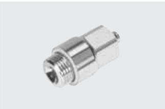
不锈钢接头, 用于频繁清洗的场合。最高耐腐蚀等级 (CRC 4)。用于最高温度达 120°C、最大压力达 12 bar 的气动应用场合。适用气管外径包括 4, 6, 8 和 10 mm, 可配合连接螺纹: M5 和 G1/8 ... G3/8。
