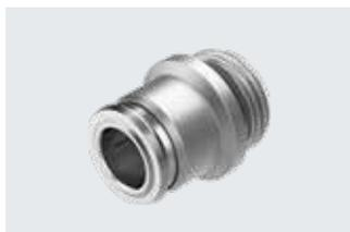
不锈钢快插接头。最高耐腐蚀等级 CRC 4, 且耐化学品。食品级, 可用于食品包装行业。用于最高温度达 150°C、最大压力达 16 bar 的气动应用场合。适用气管外径包括 4, 6, 8, 10 和 12 mm, 可配合连接螺纹: M5, M7 和 G1/8 ... G1/2。
