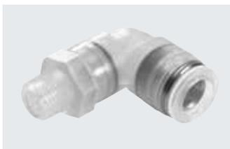
聚丙烯接头, 用于受介质影响严重的应用场合中。用于最高温度达 60°C、最大压力达 10 bar 的气动应用场合。适用气管外径包括 4, 6, 8, 10 和 12 mm, 可配合连接螺纹: R1/8 ... R1/2。
