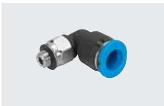
小型快插接头用于在局促的安装空间内实现最大的元件密度。用于最高温度达 80°C、最大压力达 14 bar 的气动应用场合。适用气管外径包括 2, 3, 4 和 6 mm, 可配合连接螺纹: M3, M5, M6, M7, R1/8 和 G1/8。
