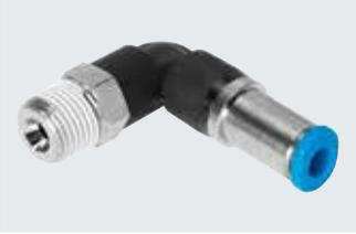
气管断开后, 阻断气流的快插接头。用于最高温度达 60°C、最大压力达 14 bar 的气动应用场合。适用气管外径包括 4, 6, 8, 10 和 12 mm, 可配合连接螺纹: M5, R1/8 ... R1/2 和 G1/8 ... G1/2。
