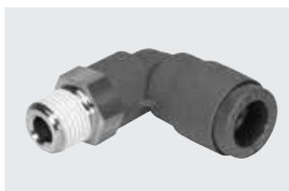
阻燃型快插接头适用于所有存在火灾风险的场合, 例如, 汽车行业和建筑行业中的焊接系统。用于最高温度达 60°C、最大压力达 10 bar 的气动应用场合。适用气管外径包括 4, 6, 8, 10 和 12 mm, 可配合连接螺纹: R1/8 ... R1/2 和 G1/8 ... G1/2。
