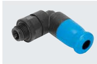
塑料接头, 可单手安装。耐水解, 符合 FDA 规定, 易于清洁。用于最高温度达 60°C、最大压力达 10 bar 的气动应用场合。适用气管外径包括 6 mm, 可配合连接螺纹: G1/8。
