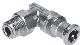
不锈钢快插接头。高耐腐蚀等级 CRC 4, 且耐化学品, 经认证可用于食品包装行业。用于最高温度达 120°C、最大压力达 10 bar 的气动应用场合。适用气管外径包括 4, 6, 8, 10, 12 和 16 mm, 可配合连接螺纹: M5 和 R1/8 ... R1/2。
