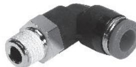
多种快插接头选择, 用于最高温度达 80°C、最大压力达 14 bar 的气动应用场合。适用气管外径包括 4, 6, 8, 10, 12, 16 和 22 mm, 可配合连接螺纹: R1/8 ... R1/2 和 G1/8 ... G3/4。
