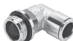
价格实惠的金属快插接头, 用于最高温度 70°C、最大压力达 16 bar 的气动应用场合。适用气管外径包括 3, 4, 6, 8, 10, 12 和 14 mm, 可配合连接螺纹: M5, M7 和 G1/8 ... G1/2。
