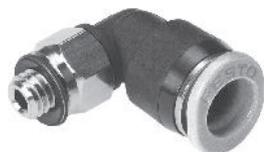
小型快插接头用于在局促的安装空间内实现最大的元件密度。用于最高温度达 80°C、最大压力达 14 bar 的气动应用场合。适用气管外径包括 2, 3, 4 和 6 mm, 可配合连接螺纹: M3, M5, M6, M7, R1/8 和 G1/8。
