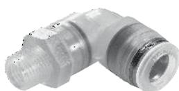
聚丙烯接头, 用于受介质影响严重的应用场合中。用于最高温度达 60°C、最大压力达 10 bar 的气动应用场合。适用气管外径包括 4, 6, 8, 10 和 12 mm, 可配合连接螺纹: R1/8 ... R1/2。
