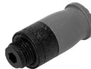
塑料接头, 可单手安装。耐水解, 符合 FDA 规定, 易于清洁。用于最高温度达 60°C、最大压力达 10 bar 的气动应用场合。适用气管外径包括 6 mm, 可配合连接螺纹: G1/8。
