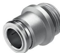
不锈钢快插接头。最高耐腐蚀等级 CRC 4, 且耐化学品。食品级, 可用于食品包装行业。用于最高温度达 150°C、最大压力达 16 bar 的气动应用场合。适用气管外径包括 4, 6, 8, 10 和 12 mm, 可配合连接螺纹: M5, M7 和 G1/8 ... G1/2。
