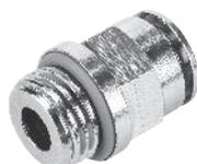
坚固的金属快插接头均为镀镍黄铜(采用化学方法)材质。高耐腐蚀等级 CRC 3, 且耐化学品。用于最高温度达 150°C、最大压力达 20 bar 的气动应用场合。适用气管外径包括 4, 6, 8, 10, 12 和 14 mm, 可配合连接螺纹: M5, M7 和 G1/8 ... G1/2。
