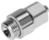
不锈钢接头, 用于频繁清洗的场合。最高耐腐蚀等级 (CRC 4)。用于最高温度达 120°C、最大压力达 12 bar 的气动应用场合。适用气管外径包括 4, 6, 8 和 10 mm, 可配合连接螺纹: M5 和 G1/8 ... G3/8。
