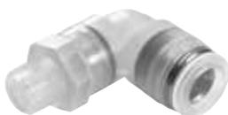
聚丙烯接头，用于受介质影响严重的应用场合中。用于最高温度达 60°C、最大压力达 10 bar 的气动应用场合。适用气管外径包括 4, 6, 8, 10 和 12 mm，可配合连接螺纹：R1/8 ... R1/2。
