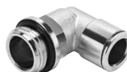
价格实惠的金属快插接头，用于最高温度 70°C、最大压力达 16 bar 的气动应用场合。适用气管外径包括 3, 4, 6, 8, 10, 12 和 14 mm，可配合连接螺纹：M5, M7 和 G1/8 ... G1/2。
