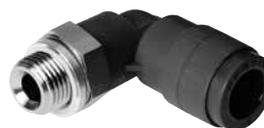
阻燃型快插接头适用于所有存在火灾风险的场合，例如，汽车行业和建筑行业中的焊接系统。用于最高温度达 60°C、最大压力达 10 bar 的气动应用场合。适用气管外径包括 4, 6, 8, 10 和 12 mm，可配合连接螺纹：R1/8 ... R1/2 和 G1/8 ... G1/2。R1/8 ... R1/2 and G1/8 ... G1/2。
