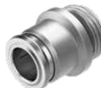
不锈钢快插接头。最高耐腐蚀等级 CRC 4，且耐化学品。食品级，可用于食品包装行业。用于最高温度达 150°C、最大压力达 16 bar 的气动应用场合。适用气管外径包括 4, 6, 8, 10 和 12 mm，可配合连接螺纹：M5, M7 和 G1/8 ... G1/2。
