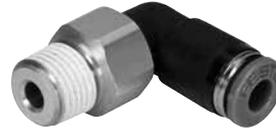
快插接头, 带旋转接口, 可旋转 360°。滚珠轴承在旋转运动场合中最大转速可达 500 rpm。用于最高温度达 60°C、最大压力达 14 bar 的气动应用场合。适用气管外径包括 4, 6, 8, 10 和 12 mm, 可配合连接螺纹: M5, R1/8 ... R1/2 和 G1/8 ... G1/2。
