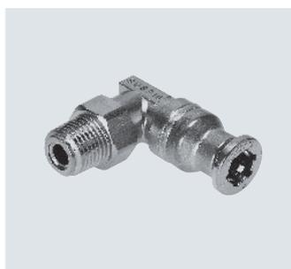
不锈钢快插接头。高耐腐蚀等级 CRC 4，且耐化学品，经认证可用于食品包装行业。用于最高温度达 120°C、最大压力达 10 bar 的气动应用场合。适用气管外径包括 4, 6, 8, 10, 12 和 16 mm，可配合连接螺纹：M5 和 R1/8 ... R1/2。
