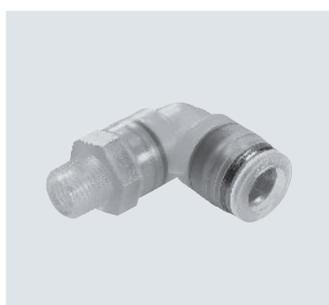
聚丙烯接头，用于受介质影响严重的应用场合中。用于最高温度达 60°C、最大压力达 10 bar 的气动应用场合。适用气管外径包括 4, 6, 8, 10 和 12 mm，可配合连接螺纹：R1/8 ... R1/2。
