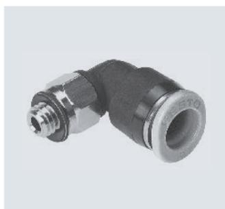
小型快插接头用于在局促的安装空间内实现最大的元件密度。用于最高温度达 80°C，最大压力达 14 bar 的气动应用场合。适用气管外径包括 2, 3, 4 和 6 mm，可配合连接螺纹：M3, M5, M6, M7, R1/8 和 G1/8。
