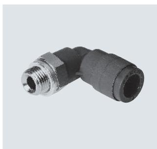
阻燃型快插接头适用于所有存在火灾风险的场合，例如，汽车行业和建筑行业中的焊接系统。用于最高温度达 60°C、最大压力达 10 bar 的气动应用场合。适用气管外径包括 4, 6, 8, 10 和 12 mm，可配合连接螺纹：R1/8 ... R1/2 和 G1/8 ... G1/2。
