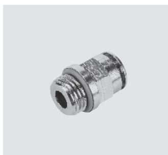
坚固的金属快插接头均为镀镍黄铜（采用化学方法）材质。高耐腐蚀等级 CRC 3，且耐化学品。用于最高温度达 150°C、最大压力达 20 bar 的气动应用场合。适用气管外径包括 4, 6, 8, 10, 12 和 14 mm，可配合连接螺纹：M5, M7 和 G1/8 ... G1/2。
