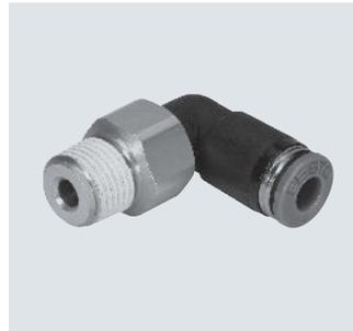
快插接头, 带旋转接口, 可旋转 360°。滚珠轴承在旋转运动场合中最大转速可达 500 rpm。用于最高温度达 60°C、最大压力达 14 bar 的气动应用场合。适用气管外径包括 4, 6, 8, 10 和 12 mm, 可配合连接螺纹: M5, R1/8 ... R1/2 和 G1/8 ... G1/2
