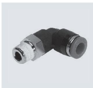
多种快插接头选择，用于最高温度达 80°C、最大压力达 14 bar 的气动应用场合。适用气管外径包括 4, 6, 8, 10, 12, 16 和 22 mm，可配合连接螺纹：R1/8 ... R1/2 和 G1/8 ... G3/4。
