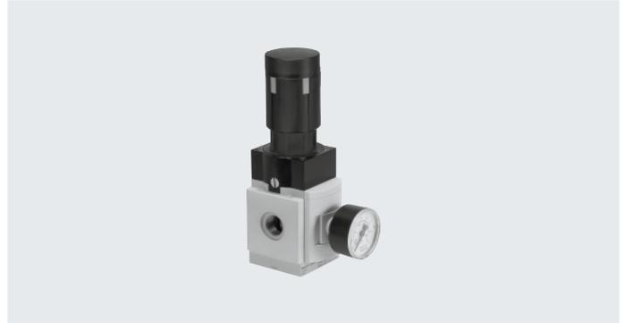
精密减压阀用于迟滞要求在 0.02 bar 的敏感型应用场合。输出压力  $p_2$  在压力调节范围可用旋转手柄手动设置或通过外部先导减压阀的先导压力  $p_{12}$  气动设置（如可能，请使用精密减压阀）。当切断输入压力  $p_1$  时，输出压力  $p_2$  通过气口 3（二级排气）排气。
