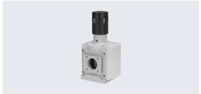
减压阀维持必要的恒定输出压力 p2，不受系统压力波动和耗气量的影响。输出压力 p2 在压力调节范围可用旋转手柄手动设置或通过外部先导减压阀的先导压力 p12 气动设置（如可能，请使用精密减压阀）。当切断输入压力 p1 时，输出压力 p2 通过气口 3（二级排气）排气。
