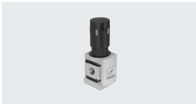
不管系统（主压）和耗气量如何波动，减压阀保持工作压力（次压）的恒定。
