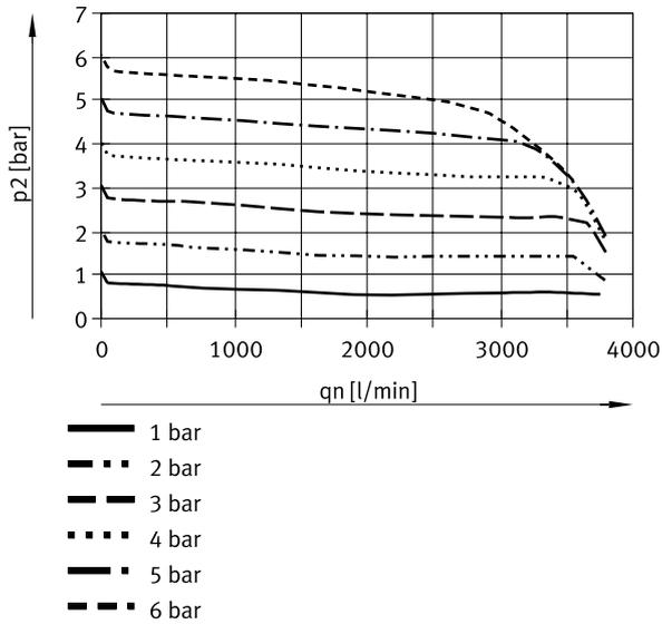
标准流量  $q_n$  与输出压力  $p_2$  ( $p_1 = 10 \text{ bar}$ ) – MS6-LFR-...-C-...-B 的关系 (过滤等级:  $5 \mu\text{m}$ )
