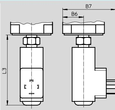
压力开关 PEV-1/4-B-OD，带可调压力开关点，方形插头，符合 DIN EN 175 301标准，A型
