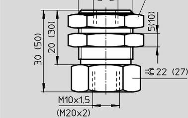
1 倒钩接头，用于3 mm 塑料气管
