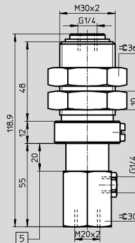
1 倒钩接头，用于3 mm 塑料气管
