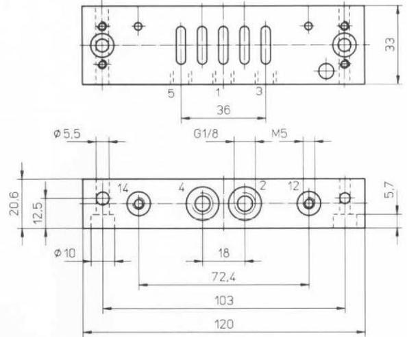
**Anschlußplatte Typ CAU-1/8**
