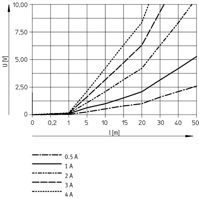
电压降U (V)，用于电缆横截面0.25 mm<sup>2</sup>带M12
