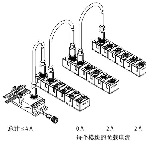
**带M12接口电缆的电压降**
