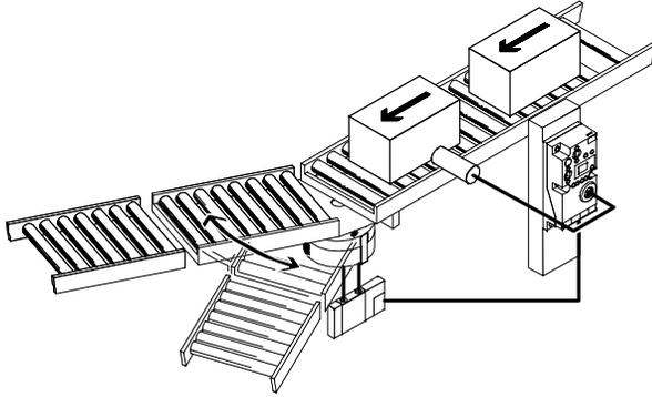
由于单个阀接口ASI-EVA电缆引线经过加长，所以AS-i就可采用新型简便的安装方式。
