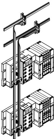
使用扁平电缆的标准AS-i安装
