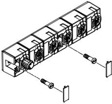
紧凑型 I/O 模块的安装孔被标签覆盖。
