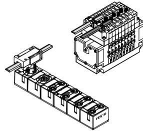
如果分支末端是一个输入模块，那么扁平电缆同样可以通过特别密封的接头布线。
