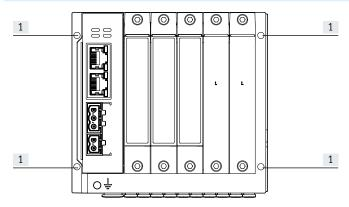
La placa de enlace dispone de cuatro taladros pasantes [1] para montar el terminal de válvulas. NUEVO Terminal de válvulas VTEP
