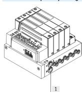
El terminal de válvulas VTEP recibe presión a través de las conexiones [1] de la placa de enlace.
