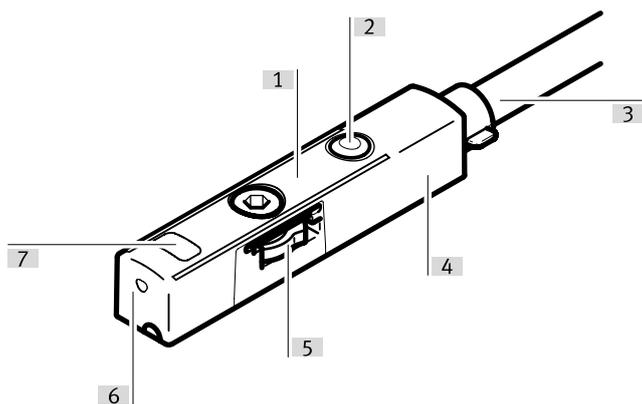
[1] Teach-in automático: el sensor de proximidad detecta la posición final de la carrera del émbolo y allí aprende automáticamente el punto de conmutación durante el funcionamiento
