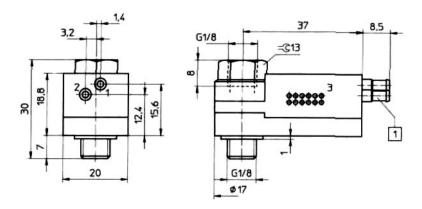
[1] Boquilla de enchufe para tubo de plástico NW3
