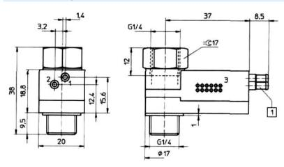
[1] Boquilla de enchufe para tubo de plástico NW3
