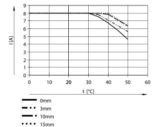
Para que la unidad alcance al menos la vida útil especificada, pueden ser necesarias distancias de montaje para corrientes de salida > 4,6 A. Las distancias de montaje necesarias dependen de la temperatura ambiente t y de la corriente de salida I.
