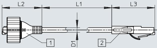
[1] Lado del dispositivo de campo, conexión eléctrica 1: RJ45
