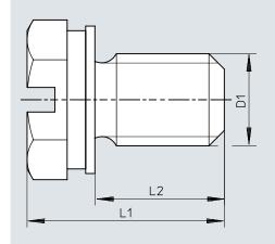
Dimensiones – Tapón ciego B-M3-S9, con hexágono exterior y anillo de junta
