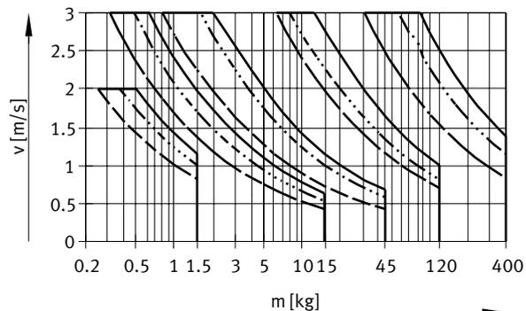
Für jeden Stoßdämpfer sind drei Kraftkurven eingezeichnet. Für Zwischenwerte muss gemittelt werden.
