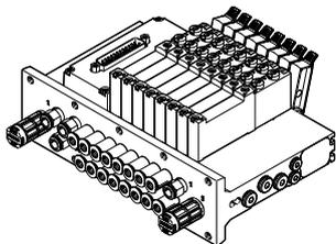
Absperrfunktion für Kanal 1, für Anschlussplattenventile M7 (Baugröße 10) und G1/8 (Baugröße 14):
