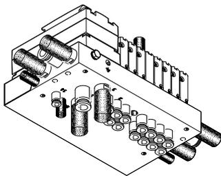
Für Anschlussplattenventile M7 (Baugröße 10), G1/8 (Baugröße 14) und G1/4 (Baugröße 18).
