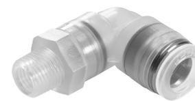
Polypropylenverschraubung für den Einsatz bei Anwendungen mit extremen Medieneinflüssen. Für Pneumatikanwendungen mit einem Temperaturbereich bis 60 °C und einem Druckbereich bis 10 bar.
