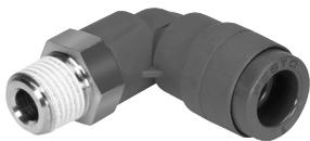
Flammhemmende Steckverschraubung für den Einsatz in allen brandgefährdeten Bereichen, wie zum Beispiel Schweißanlagen in der Automobilindustrie, sowie Gebäudebau. Für Pneumatikanwendungen mit einem Temperaturbereich bis 60 °C und einem Druckbereich bis 10 bar.
