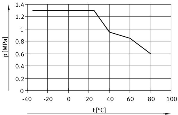
Betriebsdruck  $p$  in Abhängigkeit von der Temperatur  $t$  (Medium: Wasser)
