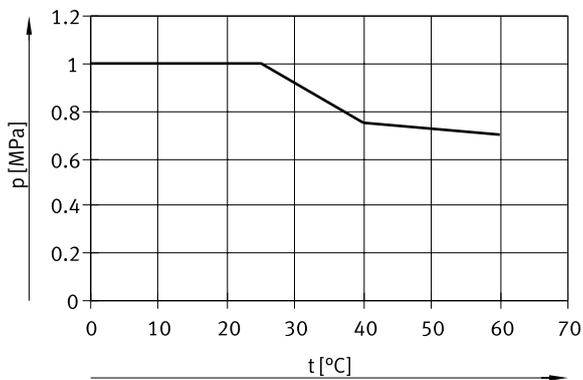
Für das Medium Wasser gelten ein eingeschränkter Temperaturbereich und abweichende maximale Betriebsdrücke, mit einem Sicherheitsfaktor von  $s=4$ .
