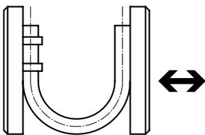
Der auf der Grundplatte fixierte Schlauch wird solange gebogen bis die Deformierung zum Knick führt. Der gemessene Wert ist der minimale Biegeradius  $R_{min}$ . Dieser  $R_{min}$  führt zu erheblichen Durchflussreduzierungen.
