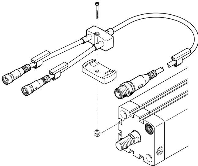
Die NEDY Verteiler besitzen am Verteilergehäuse eine Durchgangsbohrung passend für M2-Schraube.
