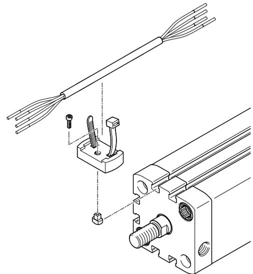
Der Befestigungsbausatz gewährleistet eine sichere Montage in T-Nuten von Festo. Die Geometrie des Halters und auch des Nutensteines sind exakt darauf angepasst.
