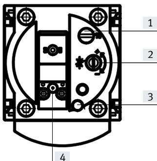
[1] Schraube zur Einstellung des Druckumschaltpunkts
