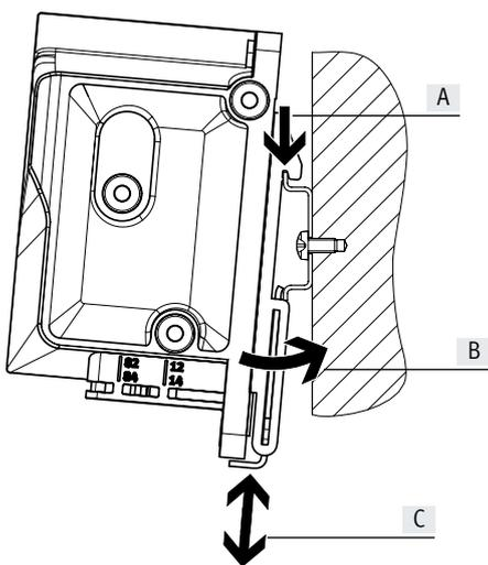
El terminal de válvulas VTUX se engancha en el perfil DIN (véase la flecha A). A continuación, el terminal de válvulas VTUX se bascula sobre el perfil DIN (véase la flecha B).
