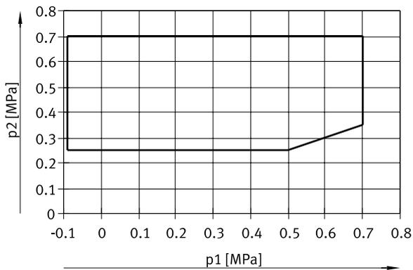
Para válvula de 5/2 vías, monoestable, reposición por muelle neumático
