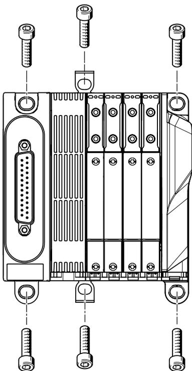
El terminal de válvulas VTUX se fija a la superficie de fijación mediante cuatro tornillos M4 o M6. Los taladros de montaje se encuentran en la conexión multipolo y en la placa final derecha. Adicionalmente se ofrecen escuadras de fijación opcionales.
