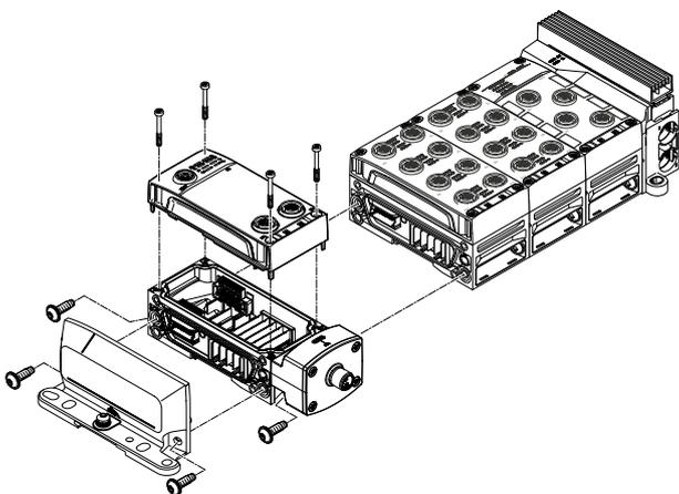
Los módulos CPX-AP-A se unen entre sí mecánicamente con tornillos inclinados. El sistema de automatización CPX-AP-A se puede ampliar de forma flexible en cualquier momento. El uso de materiales de polímero de alta calidad ha permitido aunar las ventajas del plástico (peso reducido) y del metal (robustez y compatibilidad electromagnética elevada).
