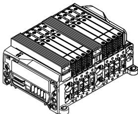
CPX-AP-A es un sistema de automatización flexible, centralizado, compacto y ligero con un grado de protección elevado IP65/IP67.
