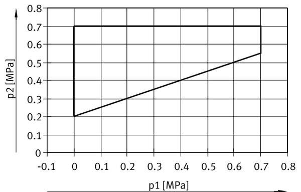
Para válvula de 2x3/2 vías. Reposición por muelle neumático
