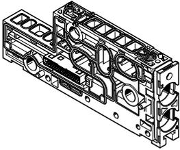
El VTUX es un sistema modular compuesto de placas de enlace y válvulas. Las placas de enlace están unidas entre sí mediante tirantes y constituyen el sistema de soporte para las válvulas. Contienen los canales de conexión para la alimentación de presión y para la descarga de aire del terminal de válvulas, además de contar con las utilidades en cada válvula para los actuadores neumáticos.
