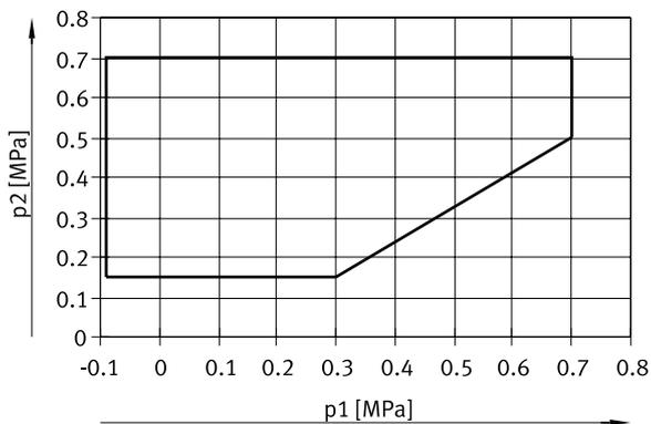
Para válvula de 2x3/2 vías. Reposición por muelle mecánico
