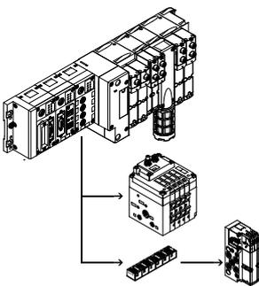
Con la ampliación opcional del ramal CP es posible conectar a hasta 4 ramales CP más terminales de válvulas y módulos I/O en el nodo de bus de campo del terminal CPX. Pueden conectarse diferentes módulos de entrada y salida, así como terminales de válvulas MPA-S y CPV.
