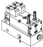
Electroválvula de 2x 5/2 vías monoestable, reposición por muelle mecánico, con detección de la posición de conmutación mediante sensor inductivo y racor de conexión M8 de 3 pines para el sensor, montaje en placa intermedia para encadenamiento neumático | PNP                   | 1112     | - <sup>1)</sup> | <b>VOFA-B26-T52-M-1C1-APP</b> |
