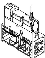
La válvula de conmutación del aire de pilotaje es una combinación de una electroválvula de 5/2 vías con detección de la posición de conmutación y la placa intermedia VABF-S4-...-S. Esta válvula permite conectar y desconectar (detección) de modo verificable la alimentación del aire de pilotaje desde el canal 1 hacia el canal 14 para toda la zona de presión o el terminal de válvulas.
