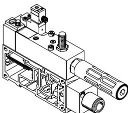
La válvula de arranque progresivo se controla eléctricamente por separado a través de un conector cuadrado forma C según EN 175301803 u, opcionalmente, con un adaptador M12, independientemente de la conexión multipolo, AS-Interface o de bus de campo.
