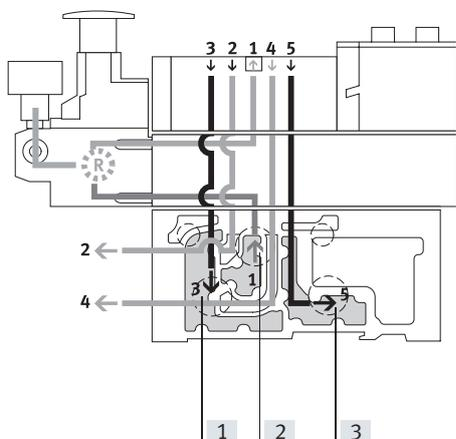
Este regulador de presión regula la presión en el canal 1, antes de la válvula. De esta manera, los canales 2 y 4 tienen la misma presión regulada.
