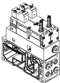
Las válvulas con detección integrada de la posición de conmutación sobre placa de enlace para terminales de válvulas VTSA/VTSA-F deben recibir alimentación eléctrica independientemente del tipo de control eléctrico del terminal de válvulas (conexión individual, multipolo, bus de campo o bloque de control).
