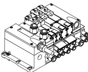
La transmisión de señales entre el control y el terminal de válvulas tiene lugar a través de un cable multifilar preconfeccionado o de una conexión multipolo de confección propia (terminal de muelle). De esta manera, se reducen notablemente el tiempo y los costes de instalación.
