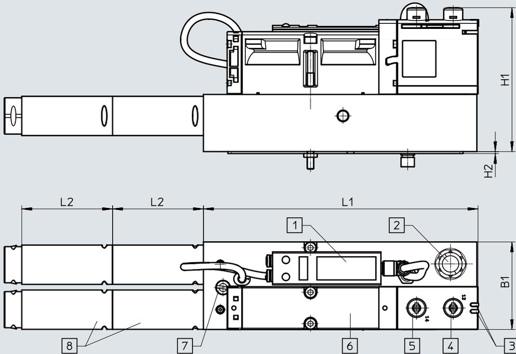
[1] Sensor de presión con pantalla LCD y teclas de mando
