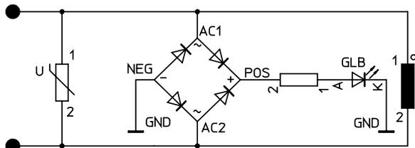
Cada bobina magnética VSVA tiene un circuito protector para supresión de arco voltaico y, además, está protegida contra inversión de la polaridad.
