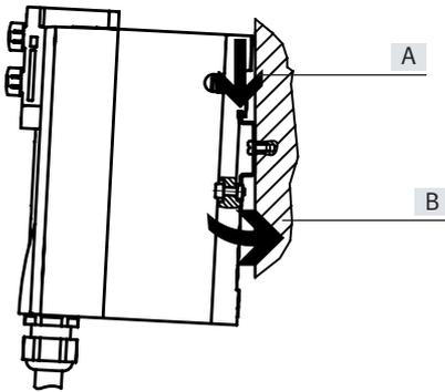
El terminal de válvulas VTSA/VTSA-F se engancha en el perfil DIN (véase la flecha A).
