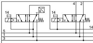
Originalmente, la función de desconexión del aire de pilotaje se obtiene combinando la placa intermedia tipo VABF-S4-...-S con la electroválvula monoestable de 5/2 vías tipo VSVA-B-M52-MZD-...-1T1L-APX-0,5. No se alimenta aire de pilotaje al terminal de válvulas a través de la placa final derecha, tipo VABE-S6-1 (código de identificación XS, aire de pilotaje externo). La conexión 14 de la placa final está cerrada.
