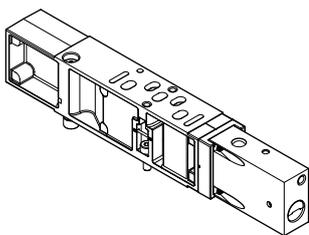
Equipada con un conmutador para bloquear la alimentación de presión. De esta manera es posible sustituir una electroválvula distribuidora o una placa de concatenación en altura posterior sin desconectar la alimentación general de aire. Si la cadena de mando es redundante, el ciclo puede continuar funcionando si el control es monocíclico.
