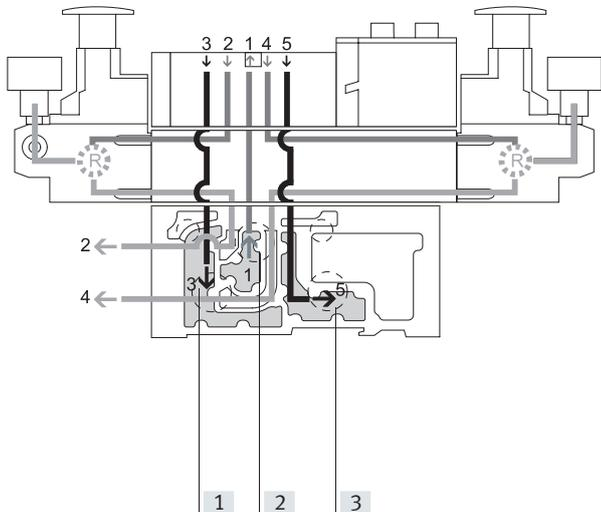
Este regulador de presión permite ajustar la presión en los canales 2 y 4 una vez que el medio de presión ha atravesado la válvula. Durante el proceso de descarga de aire, la descarga dentro de la válvula se produce a través del regulador de presión desde el canal 2 hacia el canal 3 y desde el canal 4 hacia el canal 5.
