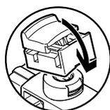
Encajar el accionamiento manual auxiliar con bloqueo sobre la válvula servopilotada.
