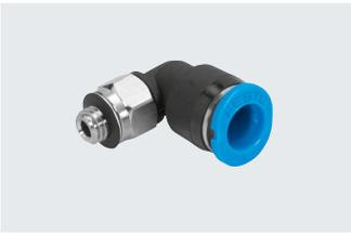
Racor rápido roscado de pequeñas dimensiones para lograr la máxima densidad de montaje en espacios reducidos. Para aplicaciones neumáticas con un margen de temperatura de hasta 80 °C y un margen de presión de hasta 14 bar.
