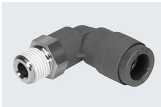
Racor rápido roscado ignífugo para la utilización en cualquier zona con peligro de incendio, por ejemplo, en equipos de soldadura en la industria automovilística o en el sector de la construcción. Para aplicaciones neumáticas con un margen de temperatura de hasta 60 °C y un margen de presión de hasta 10 bar.
