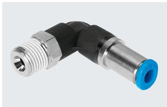
El racor rápido roscado bloquea el flujo de aire después de soltarse el tubo flexible. Para aplicaciones neumáticas con un margen de temperatura de hasta 60 °C y un margen de presión de hasta 14 bar.
