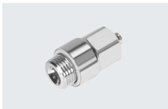
Racor de acero inoxidable para el uso en áreas expuestas a limpieza intensiva. Máxima resistencia a la corrosión CRC 4. Para aplicaciones neumáticas con un margen de temperatura de hasta 120 °C y un margen de presión de hasta 12 bar.
