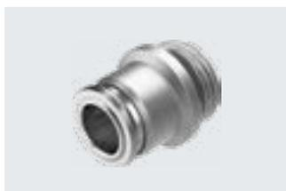
Racor rápido roscado de acero inoxidable. Máxima resistencia a la corrosión CRC 4 y a sustancias químicas. Para aplicaciones neumáticas con un margen de temperatura de hasta 150 °C y un margen de presión de hasta 16 bar.
