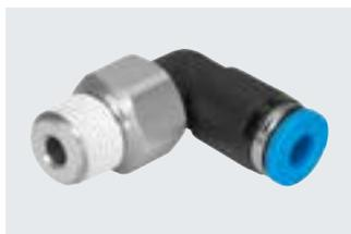
Racor rápido roscado con junta basculante, orientable 360°. El cojinete de bolas permite movimientos giratorios de hasta 500 rpm. Para aplicaciones neumáticas con un margen de temperatura de hasta 60 °C y un margen de presión de hasta 14 bar.
