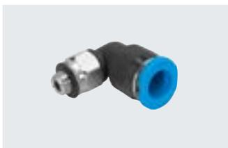
Racor rápido roscado de pequeñas dimensiones para lograr la máxima densidad de montaje en espacios reducidos. Para aplicaciones neumáticas con un margen de temperatura de hasta 80 °C y un margen de presión de hasta 14 bar.
