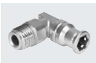
Racor rápido roscado de acero inoxidable. Máxima resistencia a la corrosión CRC 4 y a sustancias químicas; con certificación para la industria alimentaria y del envasado. Para aplicaciones neumáticas con un margen de temperatura de hasta 120 °C y un margen de presión de hasta 10 bar.
