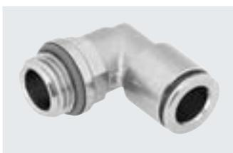
Racor metálico de latón macizo, niquelado químicamente. Resistencia a la corrosión elevada CRC 3 y a las sustancias químicas. Para aplicaciones neumáticas con un margen de temperatura de hasta 150 °C y un margen de presión de hasta 20 bar.
