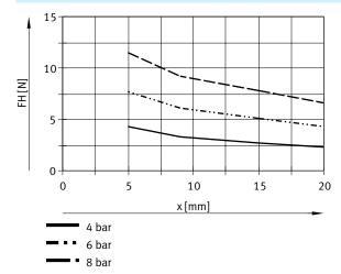
Fuerza de sujeción FH por mordaza en función de la presión de funcionamiento y del brazo de palanca x – Sujeción externa (cerrar), simple efecto – HGPM-12-EO-...
