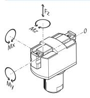
Las fuerzas y los pares admisibles indicados se aplican a una mordaza. Incluyen el brazo de palanca, las fuerzas de peso adicionales ocasionadas por la pieza o los dedos de sujeción externos y las fuerzas de aceleración que se producen durante el movimiento. Para calcular los pares, se debe tener en cuenta la posición 0 del sistema de coordenadas (guía de las mordazas).
