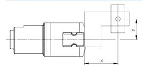
A partir de los siguientes gráficos pueden determinarse las fuerzas de sujeción a 0,6 MPa (6 bar, 87 psi) en función de la aplicación de una fuerza excéntrica y del punto excéntrico de aplicación de la fuerza máximo admisible para los diferentes tamaños.
