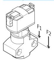
Fuerza de accionamiento teórica de la compensación de la carrera para la variante de diseño con compensación de la carrera.
