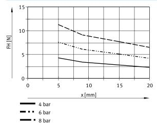
Fuerza de sujeción FH por mordaza en función de la presión de funcionamiento y del brazo de palanca x – Sujeción interior (abrir), simple efecto – HGPM-08-EZ-...
