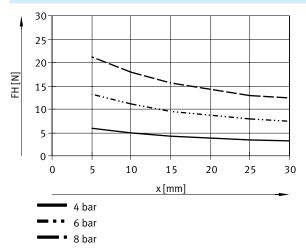
Fuerza de sujeción FH por mordaza en función de la presión de funcionamiento y del brazo de palanca x – Sujeción interior (abrir), simple efecto – HGPM-12-EZ-...
