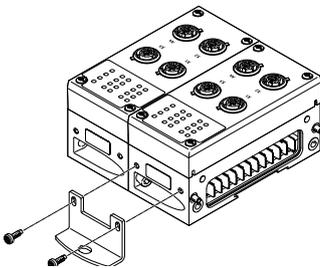
Tratándose de terminales de válvulas más largos, puede recurrirse a escuadras de fijación adicionales para el terminal CPX-P que se atornillan a los módulos de encadenamiento.
