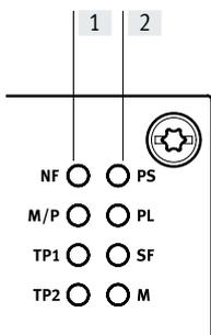
[1] Diodos emisores de luz específicos del bus de campo
