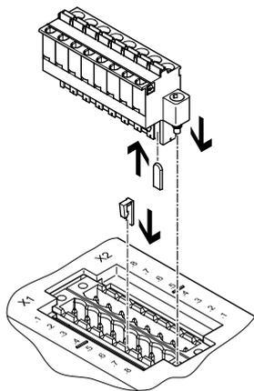
Los bloques de conexión CPX-P-AB-2XKL-8POL y CPX-P-AB-2XKL-8POL-8DE-N-IS y los zócalos NECU-L3G8 pueden asignarse entre sí con los elementos codificados CPX-P-KDS-AB-2XKL.
