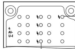
[1] Diodo emisor de luz de error (rojo; error de módulo)
