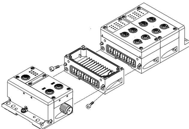
Los módulos CPX-P se unen entre sí mecánicamente mediante tornillos inclinados.
