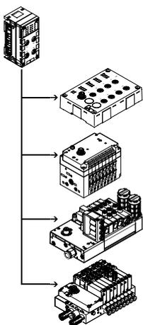
La conexión eléctrica del maestro CPX-P CTEL establece la conexión con módulos con interfaz I-Port (dispositivo) de la familia CTEL/CTEU. Los datos de entrada/salida de los dispositivos conectados son transmitidos a los nodos de bus CPX-P conectados y, de esta manera, al control de nivel superior mediante el bus de campo. Mediante las correspondientes interfaces M12 se pueden conectar un máximo de 4 dispositivos a un maestro CPX-P CTEL.
