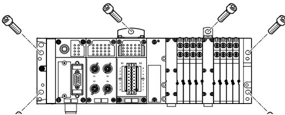
Las placas finales del terminal CPX-P y del terminal de válvulas y la interfaz neumática están provistas de taladros de fijación para el montaje mural. Si los terminales de válvulas son más largos, puede recurrirse a las fijaciones adicionales para el terminal CPX-P.
