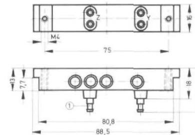
① Stecknippel für Kunststoffschlauch NW 3
