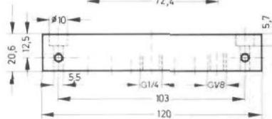
**Anschlußplatte Typ CAB-1/4**
