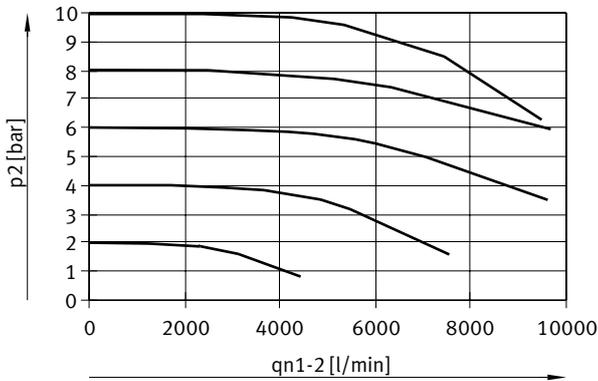
Durchfluss  $q_n$  von 2 → 3 in Abhängigkeit vom Ausgangsüberdruck  $p_2$ , VPPM-12L-...-0L2H-... (4 bar)
