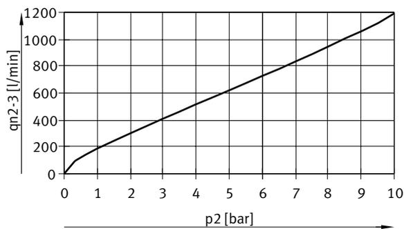
Durchfluss  $q_n$  von 1 → 2 in Abhängigkeit vom Ausgangsüberdruck  $p_2$ , VPPM-8L/F-...-0L2H-... (2 bar)
