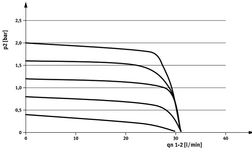
Durchfluss  $q_n$  von 2 → 3 in Abhängigkeit von Ausgangsdruck  $p_2$
