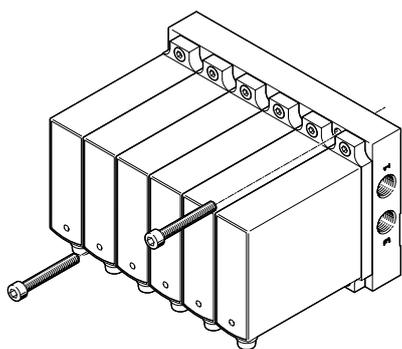
Die Anschlussleiste verfügt ebenfalls über Durchgangsbohrungen für die Wandmontage.
