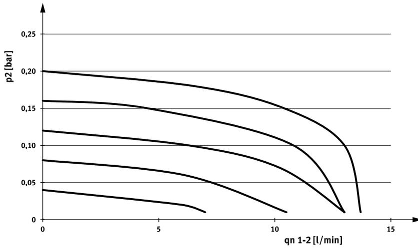
Durchfluss  $q_n$  von 2 → 3 in Abhängigkeit von Ausgangsdruck  $p_2$
