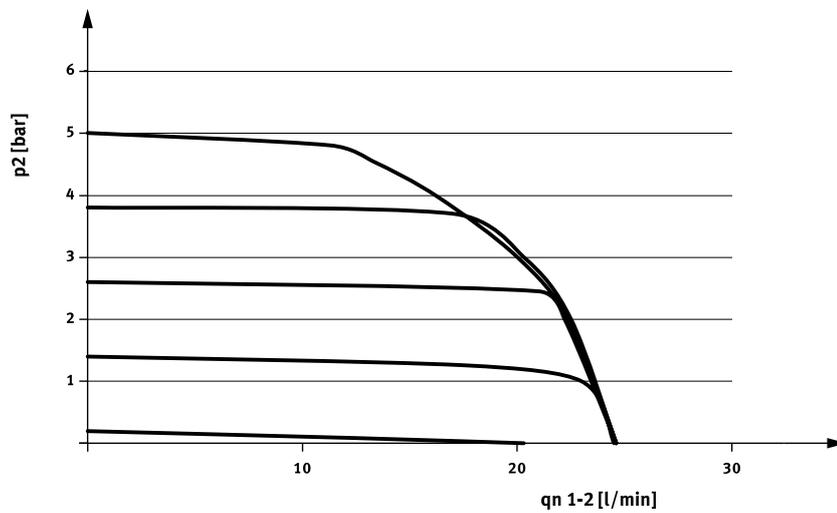
Durchfluss  $q_n$  von 2 → 3 in Abhängigkeit von Ausgangsdruck  $p_2$
