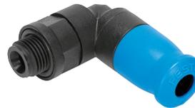
Kunststoffverschraubung für einfache Installation durch Einhandbedienung. Hydrolysebeständig, FDA konform und reinigungsfreundlich. Für Pneumatikanwendungen mit einem Temperaturbereich bis 60 °C und einem Druckbereich bis 10 bar. Schlauch-Außen- $\varnothing$  6 mm mit Anschlussgewinde G1/8.
