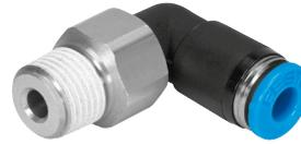
Steckverschraubung mit Schwenkanschluss, 360° rotierend. Das Kugellager ermöglicht rotierende Bewegungen in der Anwendung bis max. 500 U/min. Für Pneumatikanwendungen mit einem Temperaturbereich bis 60 °C und einem Druckbereich bis 14 bar. Schlauch-Außen- $\varnothing$  4, 6, 8, 10 und 12 mm mit Anschlussgewinde M5, R1/8 ... R1/2 und G1/8 ... G1/2.
