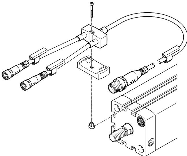
Die NEDY Verteiler besitzen am Verteilergehäuse eine Durchgangsbohrung passend für M2-Schraube. Für die Befestigung in T-Nuten steht der Befestigungsbausatz in zwei Größen zur Verfügung.
