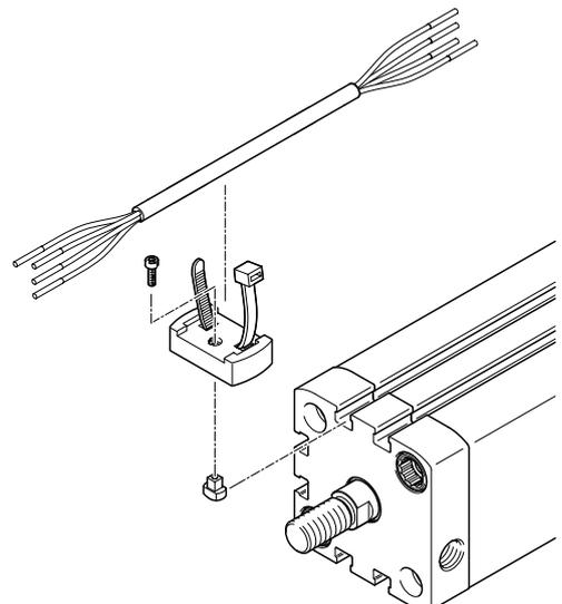
Der Befestigungsbausatz gewährleistet eine sichere Montage in T-Nuten von Festo. Die Geometrie des Halters und auch des Nutensteines sind exakt darauf angepasst.
