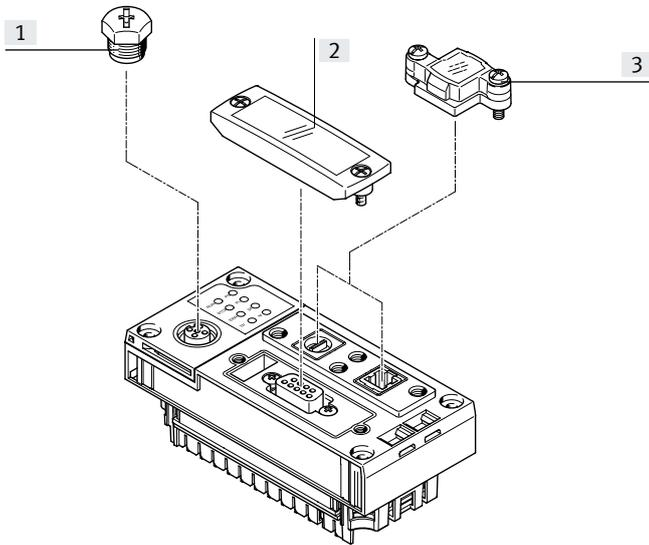
Abdeckungen werden in nicht benötigte Anschlüsse/Öffnungen eingesetzt/ingeschraubt bzw. aufgesetzt/aufgeschraubt.
