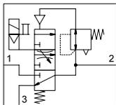
Elektrisch betätigtes Druckaufbauventil zum langsamen Be- und Entlüften von pneumatischen Anlagen.
