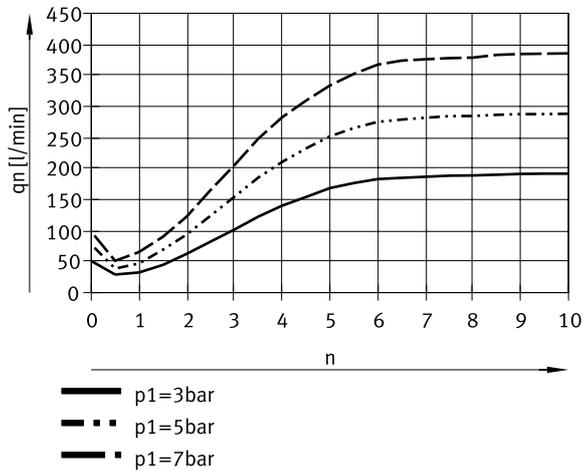
Durchfluss  $q_n$  in Abhängigkeit der Drosselschraubenumdrehungen  $n$ , gemessen: P1 gegen Umgebungsdruck (MS6-EDE-B)
