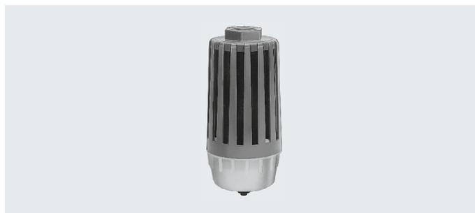
Mit dem Filter-Schalldämpfer wird die gesammelte Abluft von pneumatischen Steuerungen gereinigt. Die Abluft entweicht dabei über einen Feinfiltereinsatz (Abscheidegrad >99,99%) in die Atmosphäre..
