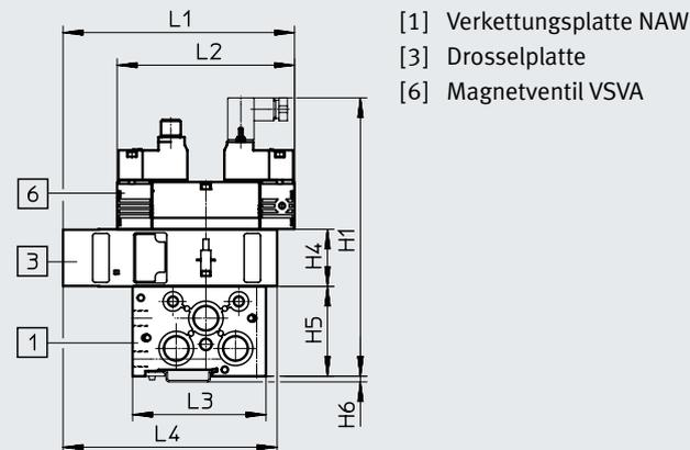
Ventilgröße 26 mm mit Verkettungsplatte und Magnetventil mit Zentralstecker
