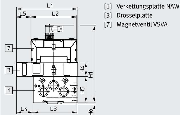
Ventilgröße 26 mm mit Verkettungsplatte und Magnetventil mit Vorsteuerschnittstelle nach ISO 15218
