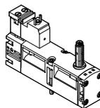
Das Wegeventil hat eine Vorsteuerung nach ISO 15218, ein Steckeranschlussbild nach EN 175301-803, Bauform C und einen induktiven Sensor.
