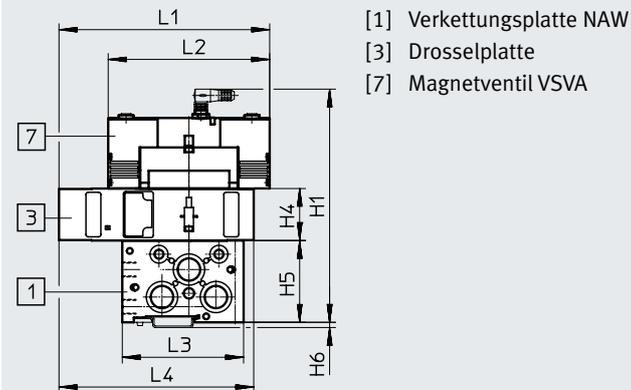
Ventilgröße 18 mm mit Verkettungsplatte und Magnetventil mit Vorsteuerschnittstelle nach ISO 15218
