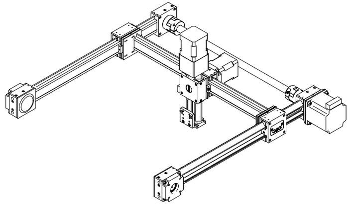
[Z2...L] Motor X-Achse links und 2 Z-Achsen
