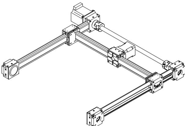
[YS1...R] Motor X-Achse rechts und 1 Schlitten
