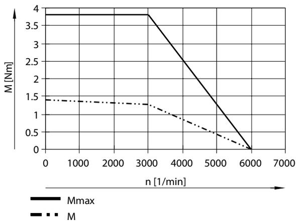
Motortypische Kennlinie bei Nennspannung und idealisiertem Motorcontroller.
