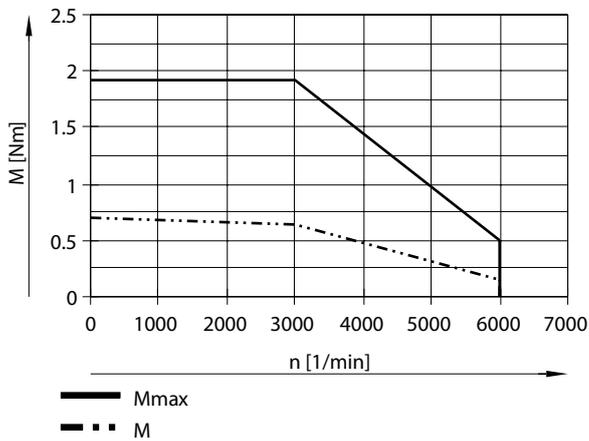
Motortypische Kennlinie bei Nennspannung und idealisiertem Motorcontroller.
