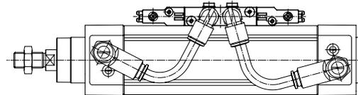
Monostabiles Ventil unbetätigt, Kolbenstange ausgefahren
