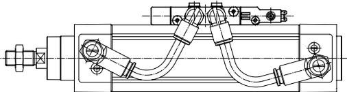
Bistabiles Ventil unbetätigt, Kolbenstange eingefahren
