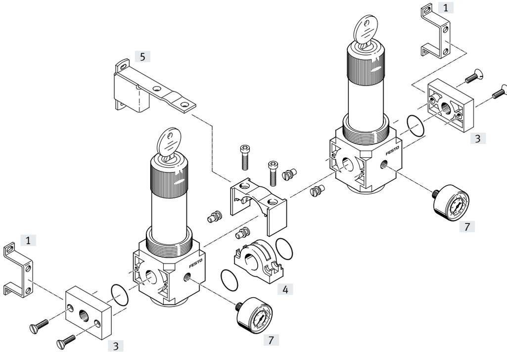
Druckregelventil LRBS abschließbar – Druckausgang vorne
