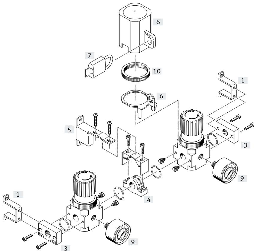
Druckregelventil LRB – Druckausgang vorne
