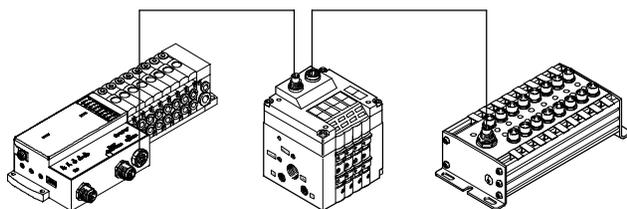
可選配的電路子線擴展，允許將附加閥島和I/O模組連接到CPV-SC Direct現場總線節點上。CP安裝系統的CP子線，作為一個擴展模組整合在現場匯流排節點上。可連接不同的輸入和輸出模組以及CPV和CPA閥島。
