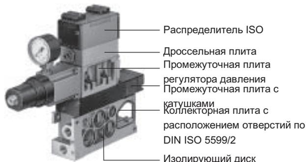
К каждой позиции распределителя между плитой и распределителем могут быть добавлены дополнительные элементы. Эти функции, реализованные в виде вертикальной компоновки, делают возможным специальную обработку или управление для соответствующей отдельной позиции распределителя.
