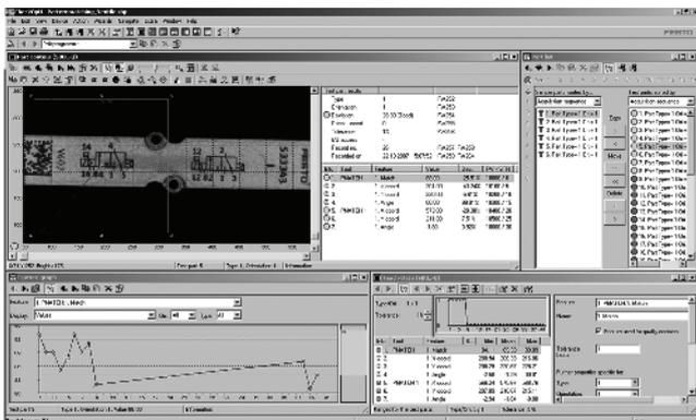
CheckOpti используется для создания/настройки рабочих программ. Записав в память образы детали, пользователь с помощью инструментов программы задает размерные и другие характеристики, которые должны контролироваться. Это делается путем выбора характеристики из списка и перетаскивания ее на изображение детали. В одной рабочей программе может быть задано/настроено до 256 контролируемых параметров. Камера может хранить до 256 рабочих программ.
