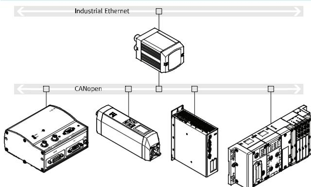
Сервоконтроллеры и устройства удаленного ввода/вывода могут быть адресованы непосредственно с помощью функции ведущего контроллера CANopen.
