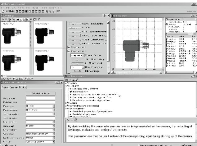
Программа CheckKon предназначена для визуализации, ведения журнала и изменения параметров работы камеры - от захвата изображения до входов/выходов.
