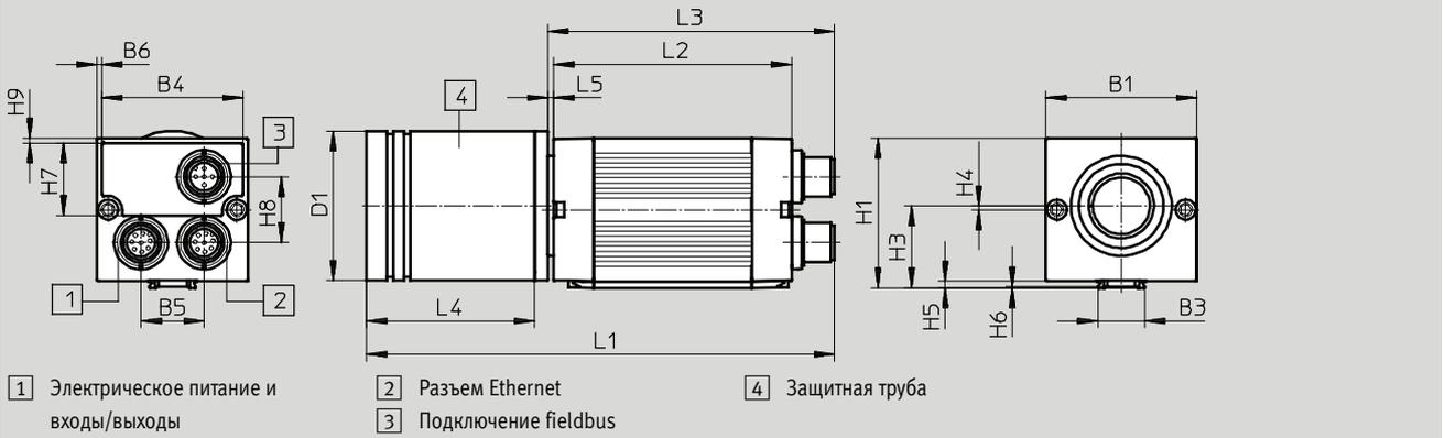
**C-тип/CS-тип крепления<sup>1)</sup> SBOC-Q-R3**
